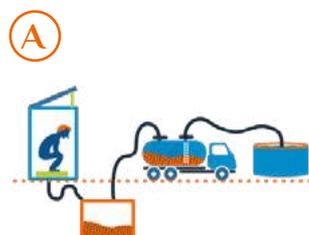
Sistema con sello hidráulico de contención en fosa séptica → transporte motorizado → disposición en alcantarillado o en almacenamiento temporal
