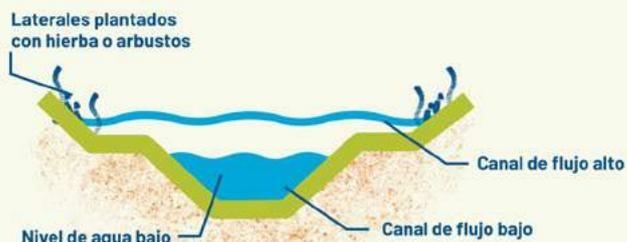
Canal compuesto para ayudar a prevenir los depósitos durante los flujos de baja velocidad.
