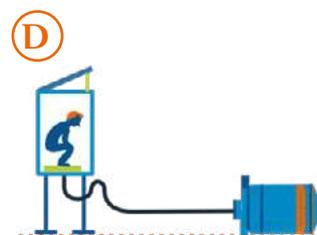
Sistema con sello hidráulico de transporte a través de alcantarillado a red de alcantarillado externa
